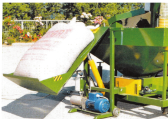
Ribaltatore per sacchi adattabile a qualsiasi pulitore Chianchia
