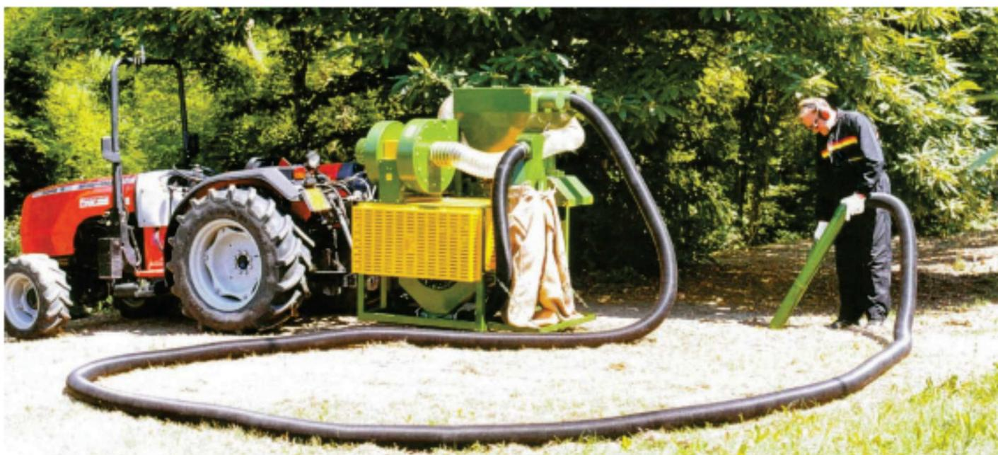
La macchina può essere utilizzata sia per la raccolta delle nocciole, utilizzando il ciclone antipolvere ed il rullo selezionatore con fori di diametro di 26 mm, sia per la raccolta delle castagne utilizzando un rullo selezionatore con fori da 45 mm di diametro. La notevole lunghezza del tubo flessibile di aspirazione facilita il raggiungimento del prodotto da raccogliere anche in zone impervie.
