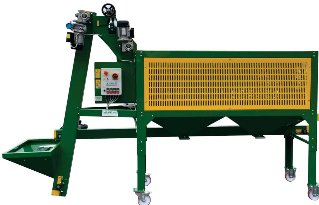
Impianto di sgusciatura per nocciole mod.P250 con sistema di sgusciatura a piastra battente. Il carico del frantoio viene effettuato mediante nastro con regolazione della velocità con inverter. La separazione del frutto dal guscio viene effettuata mediante un rullo per metà lunato e per metà forato. (la dimensione dei fori viene realizzata su richiesta del cliente)
